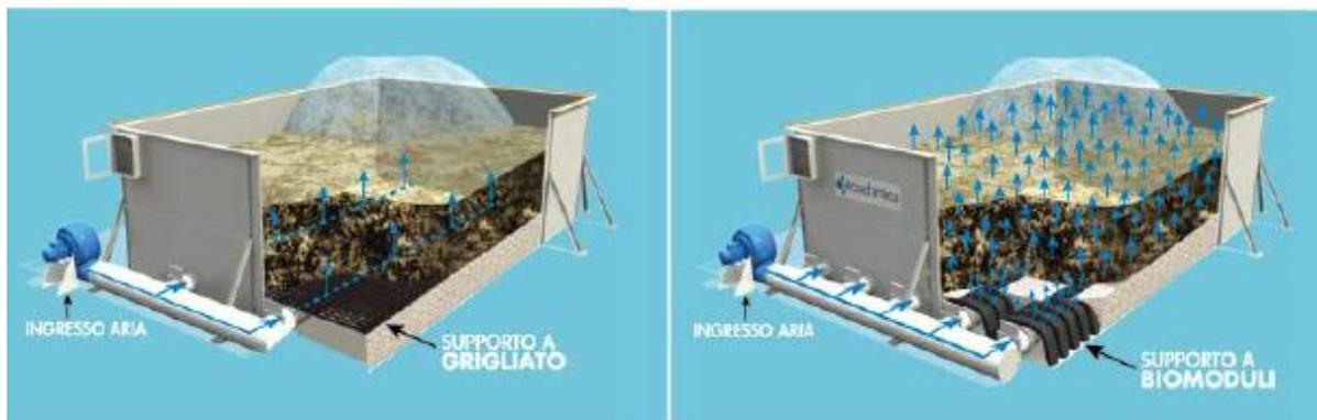
Fig. 11 Differenza di distribuzione aria tra Grigliato e supporto a Biomoduli.
