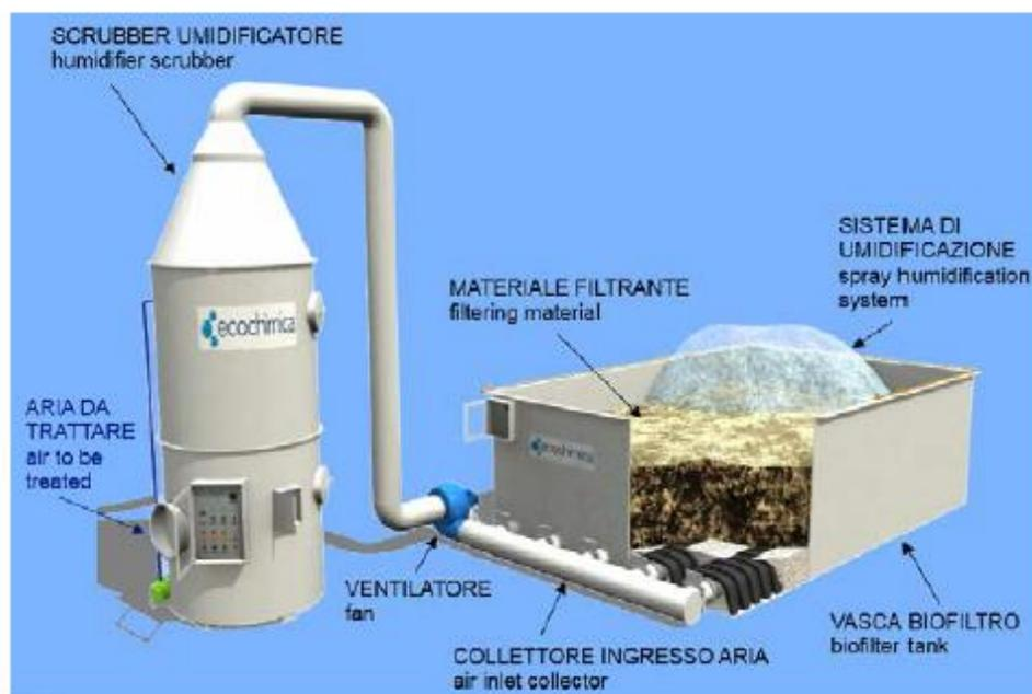
Fig.1 Schema impianto di biofiltrazione
