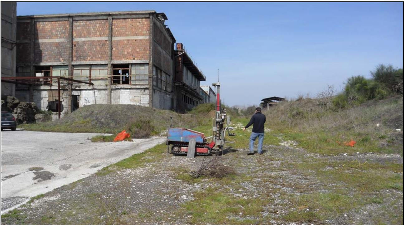
*Foto nr. 4 postazione della prova penetrometrica nr. 4*
