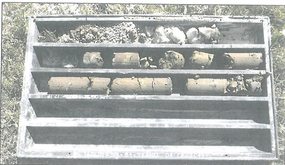
Foto nr. i 1-2 Particolare di esecuzione del sondaggio geognostico numero 1 e relativa cassetta catalogatrice
