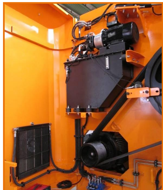
Figura 13 Particolare dell'impianto idraulico
