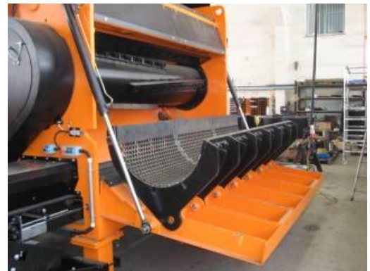
Figura 9 Con l'apertura dei portelloni il rotore, il pettine e le griglie di pezzatura sono subito disponibili per manutenzione e/o sostituzione
