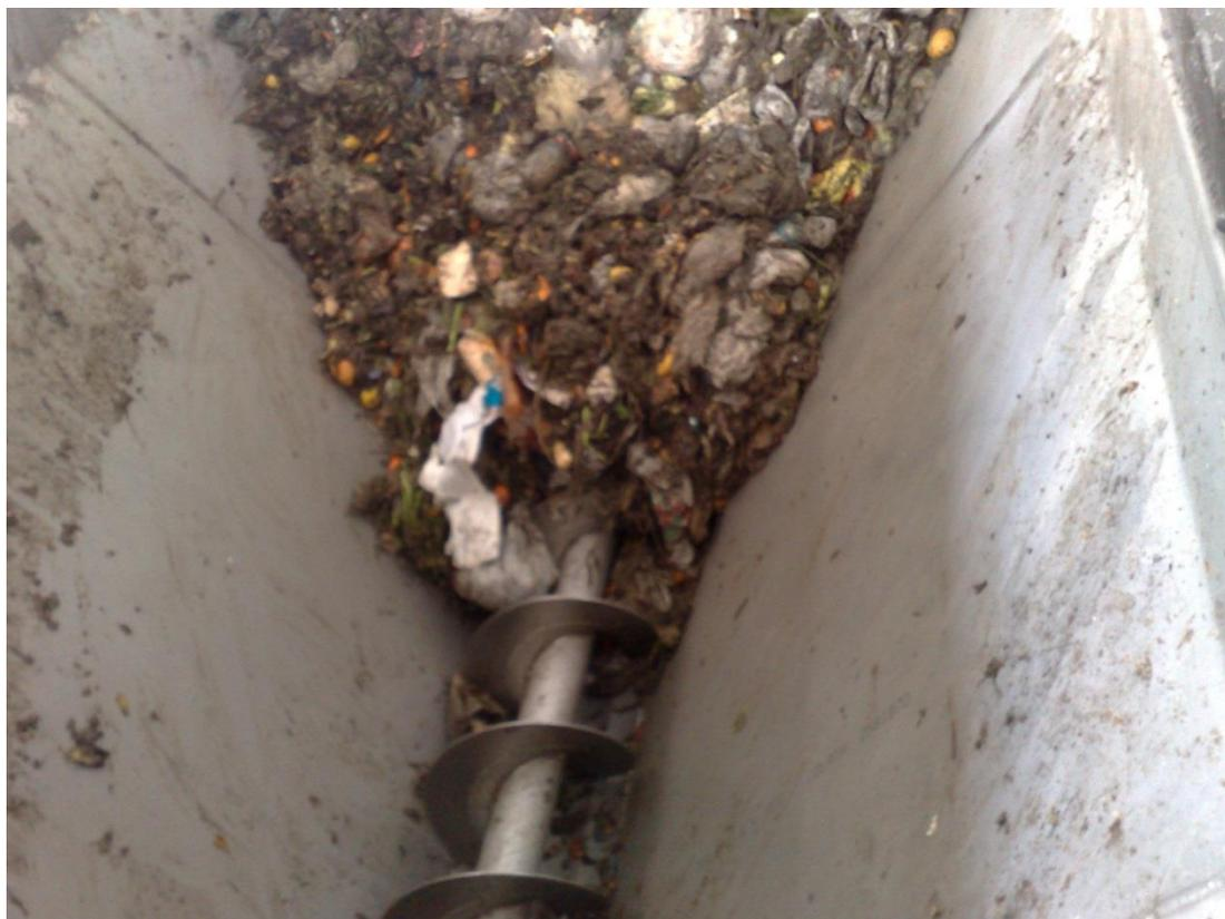
La tramoggia dosatrice è fornita completa di cofanatura esterna imbullonata, come da disegno. Per svolgere eventuali opere di pulizia, è stato realizzato un accesso a *passo d'uomo* alla base della tramoggia, così da evitare operazioni laboriose e pericolose per accedere al lato superiore della tramoggia, per calarsi all'interno e poi uscire. Lo sportello a *passo d'uomo* è ovviamente chiuso a tenuta per evitare percolazioni, ed allarmato per impedire aperture ad impianto in moto.
