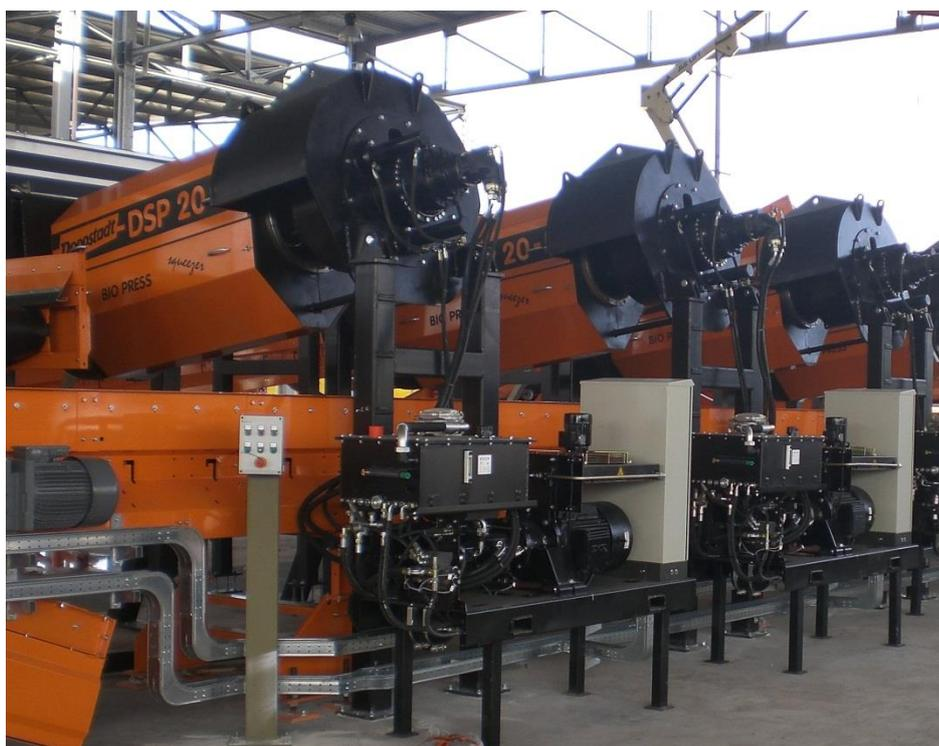
La pressione di esercizio è variabile in funzione della matrice e del risultato che si vuole ottenere e il sistema idraulico di spinta è compensato da un accumulatore ad azoto per evitare rotture per presenza di corpi estranei o eventi di "sovrappressione".
