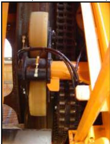
Il tamburo è alloggiato su dei supporti completi di 8 ruote folli, le quali lo tengono nella medesima posizione ed è trattenuto all'interno della struttura da altre due ruote (una anteriore ed una posteriore), che impediscono una eventuale uscita dello stesso dalla struttura.
