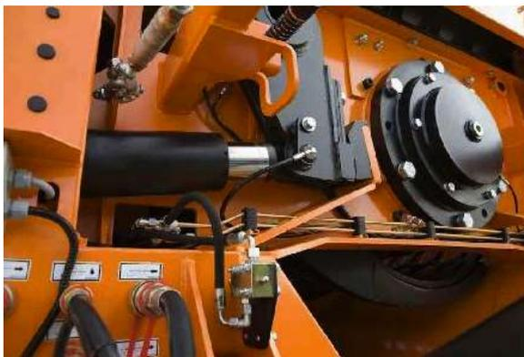
Altro vantaggio consentito dal sistema di triturbazione **DOPPSTADT** è quello di disporre di un sistema di registrazione del pettine di frantumazione mobile che consente la regolazione della pezzatura del materiale triturbato.
