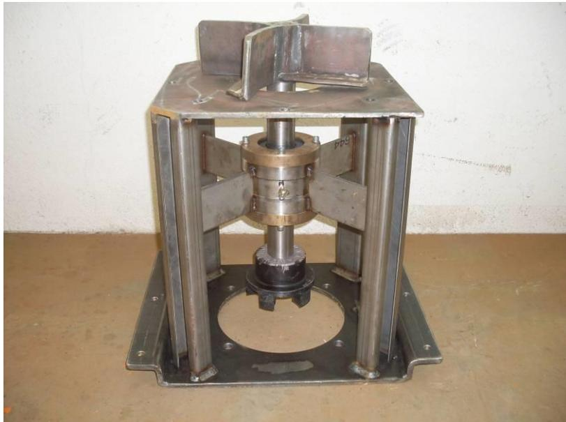
Questo dispositivo ben collaudato è utilizzabile con materiale organico pompabile (a ridotta percentuale di sostanza secca). E' alimentato da un motore da 9,2 kW. La sua potenza è in grado di raggiungere anche quote e distanze molto importanti. La pompa è fornita di integrazione hardware e software per la comunicazione con la macchina.
