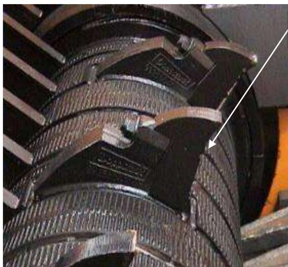
Punta di usura del dente del rotore
