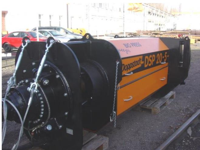
La pressione è registrabile tramite un cono comandato idraulicamente che mantiene costante la pressione sul materiale.
