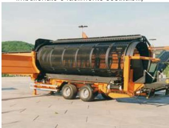
La molteplice disponibilità di forature rende possibili molteplici impieghi di lavoro. Per permettere lo scorrimento del materiale da vagliare, che altrimenti sarebbe possibile solamente con l'inclinazione del
