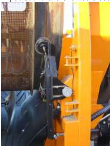
Una spazzola con setole rigide, mossa tramite pistoni idraulici, è sistemata superiormente al tamburo e permette di poterlo mantenere sempre pulito anche nelle peggiori condizioni di lavoro anche grazie al fatto di poterne regolare la distanza mediante spessori meccanici riprendendone l'usura.
