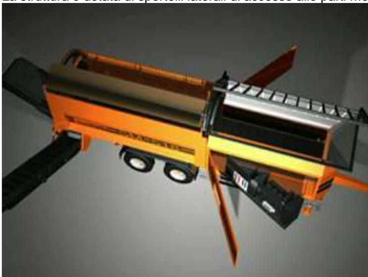
All'interno della struttura, completamente chiusa in fase di lavoro, trovano alloggiamento tutte le apparecchiature ed accessori quali, serbatoio del gasolio, apparecchiatura di comando, batterie, ecc..., necessarie al funzionamento della macchina.
