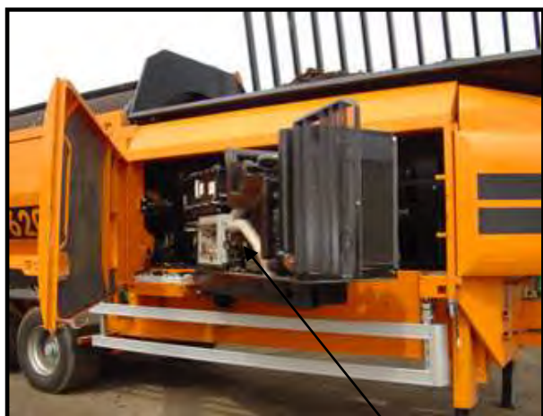
Apertura a libro del gruppo motore-impianto idraulico.
