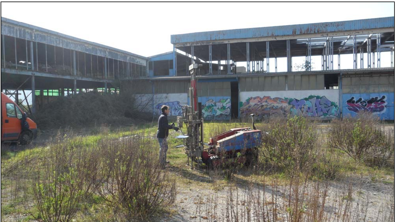
Foto nr. 1-2 postazione della prova penetrometrica nr. 1 – particolare fasi esecutive
