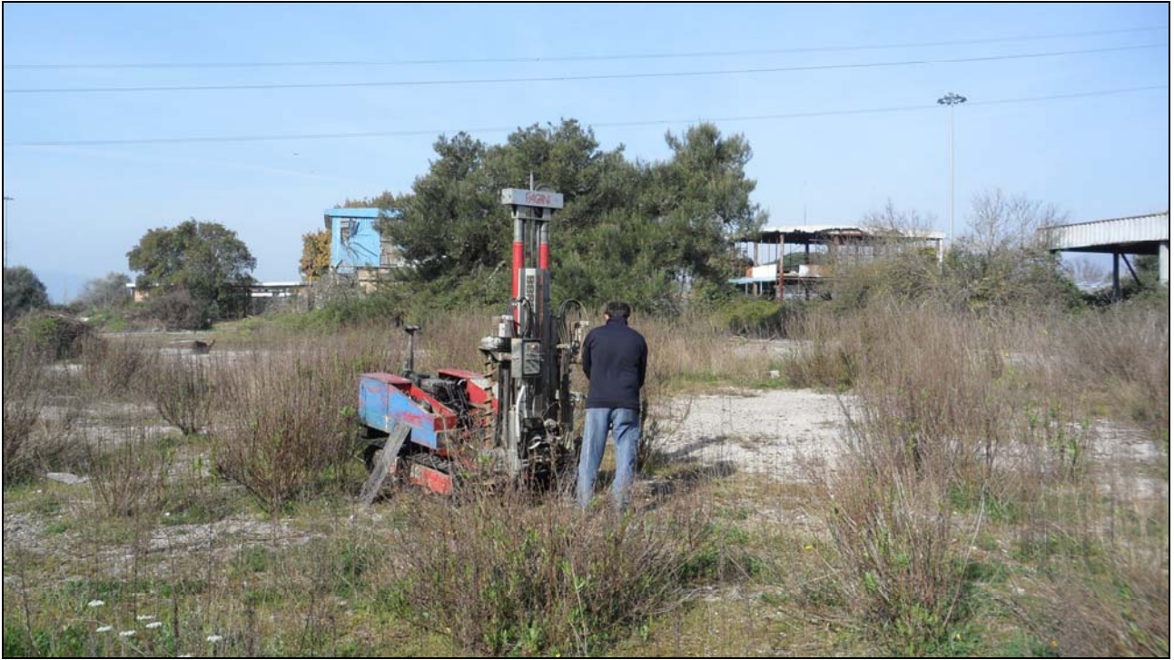
Foto nr. 1-2 postazione della prova penetrometrica nr. 1 – particolare fasi esecutive
