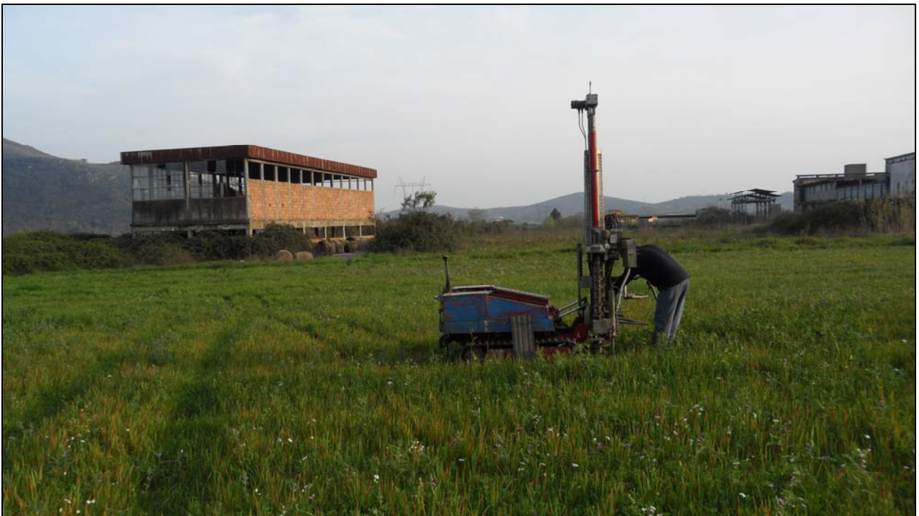
Foto nr. 8 postazione della prova penetrometrica cpt nr. 2 – particolare del posizionamento
